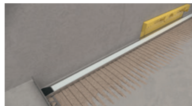
↑ Le profilé collecteur disponible en option peut être monté directement devant la paroi pour créer une pente vers l'évacuation murale. Il recueille saletés et dépôts, qui peuvent alors être simplement essuyés.
