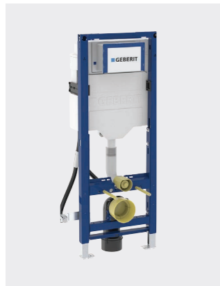
↑ 111.350.00.6 Bâti-support Geberit Duofix pour solutions adaptées aux personnes à mobilité réduite. La largeur du cadre est réduite afin de permettre la mise en place de poignées d'appui à proximité du bâti-support.
